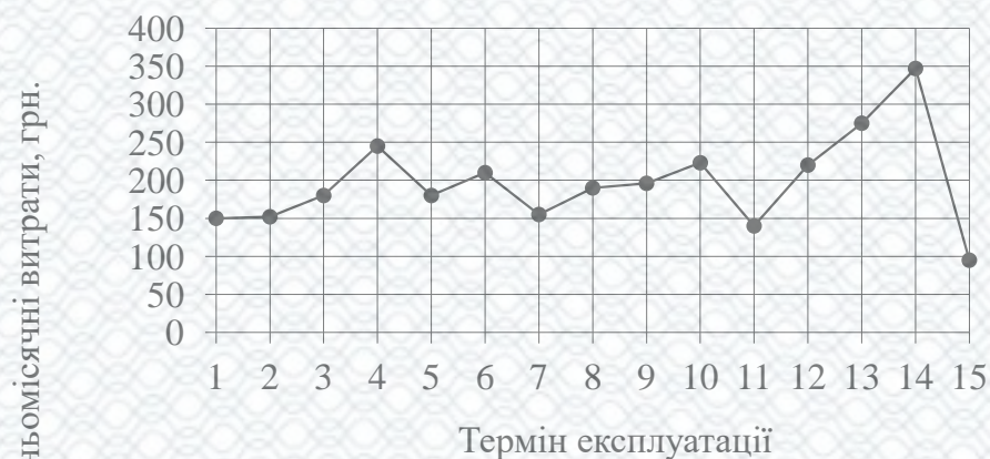
Рисунок 1.2 - Залежність витрат на технічне обслуговування та ремонт від терміну експлуатації
