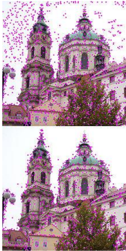
Рисунок 2.2 – Фільтрування ключових точок алгоритмом SIFT
