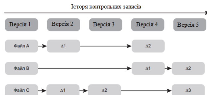
Рисунок 2.13 – Схема збереження в застарілих системах контролю версій
