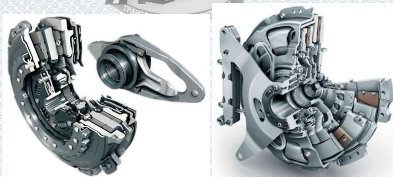
Рисунок 1.21 – Сухе подвійне зчеплення
