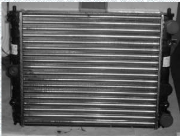
Рисунок 3.3 – Алюмінієвий трубчасто-пластинчастий радіатор непаяної конструкції з круглими трубками
