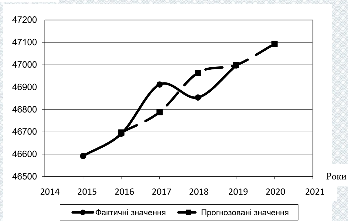
Рисунок 3.6 – Прогнозування автомобіле-годин перебування в наряді (год. в рік) автомобілів ГАЗ методом експонентного згладжування
