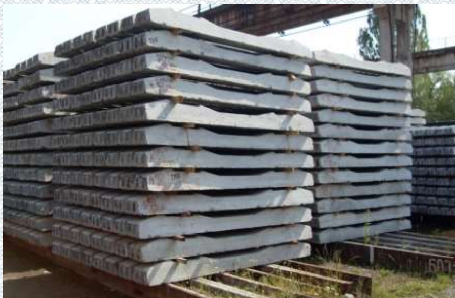
Рисунорк 1.4 – Готова продукція підприємства (залізобетонні шпали)
