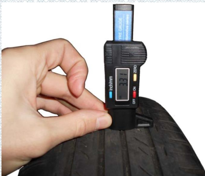
Рисунок 4.8 - Вимірювання залишкової висоти рисунку протектора бігової доріжки шини
