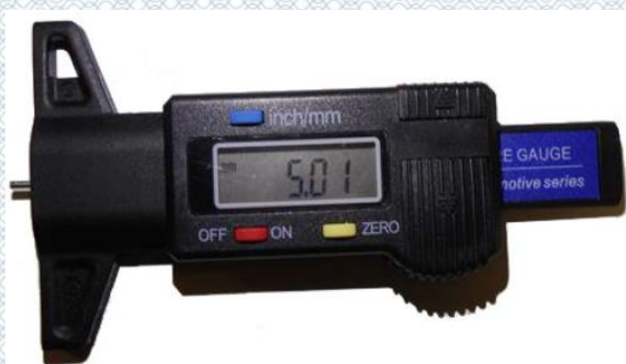
Рисунок 4.7 - Вимірювач глибини рисунку протектора шини фірми GemRed моделі QST-601
