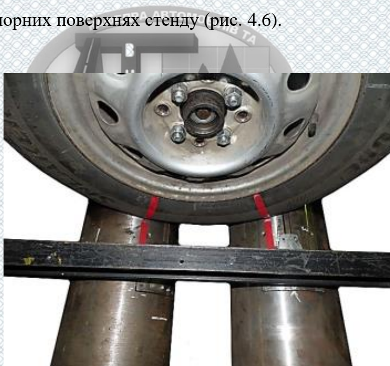
Рисунок 4.6 - Колесо, встановлене на стенді з опорними роликами і нанесеними позначками для відліку
