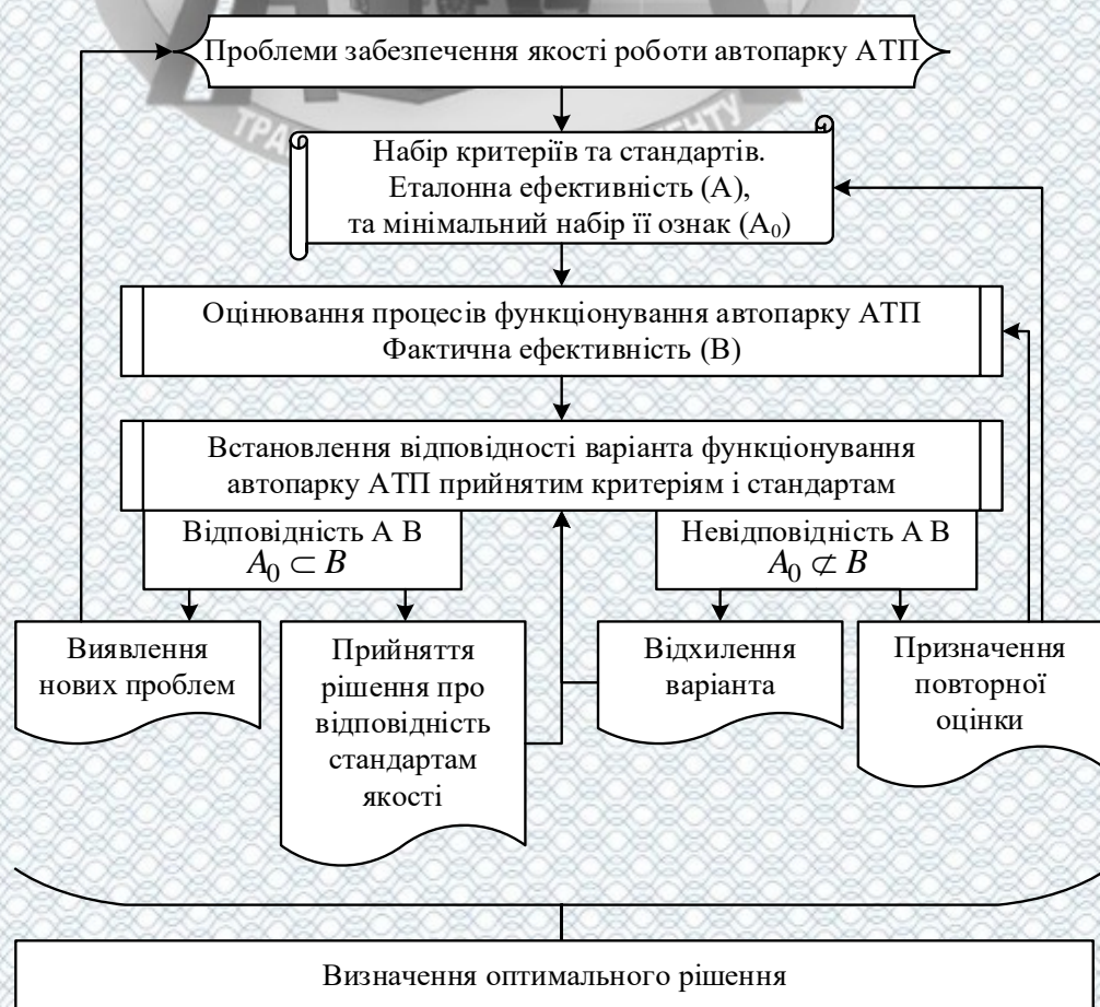
Рисунок 1.2 – Схема забезпечення якості функціонування автопарку АТП
