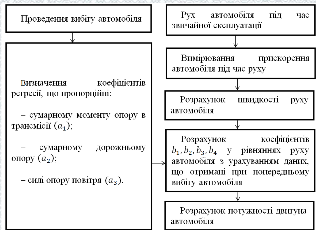
Рисунок 2.1 – Блок-схема послідовності визначення потужності двигуна автомобіля під час його руху
