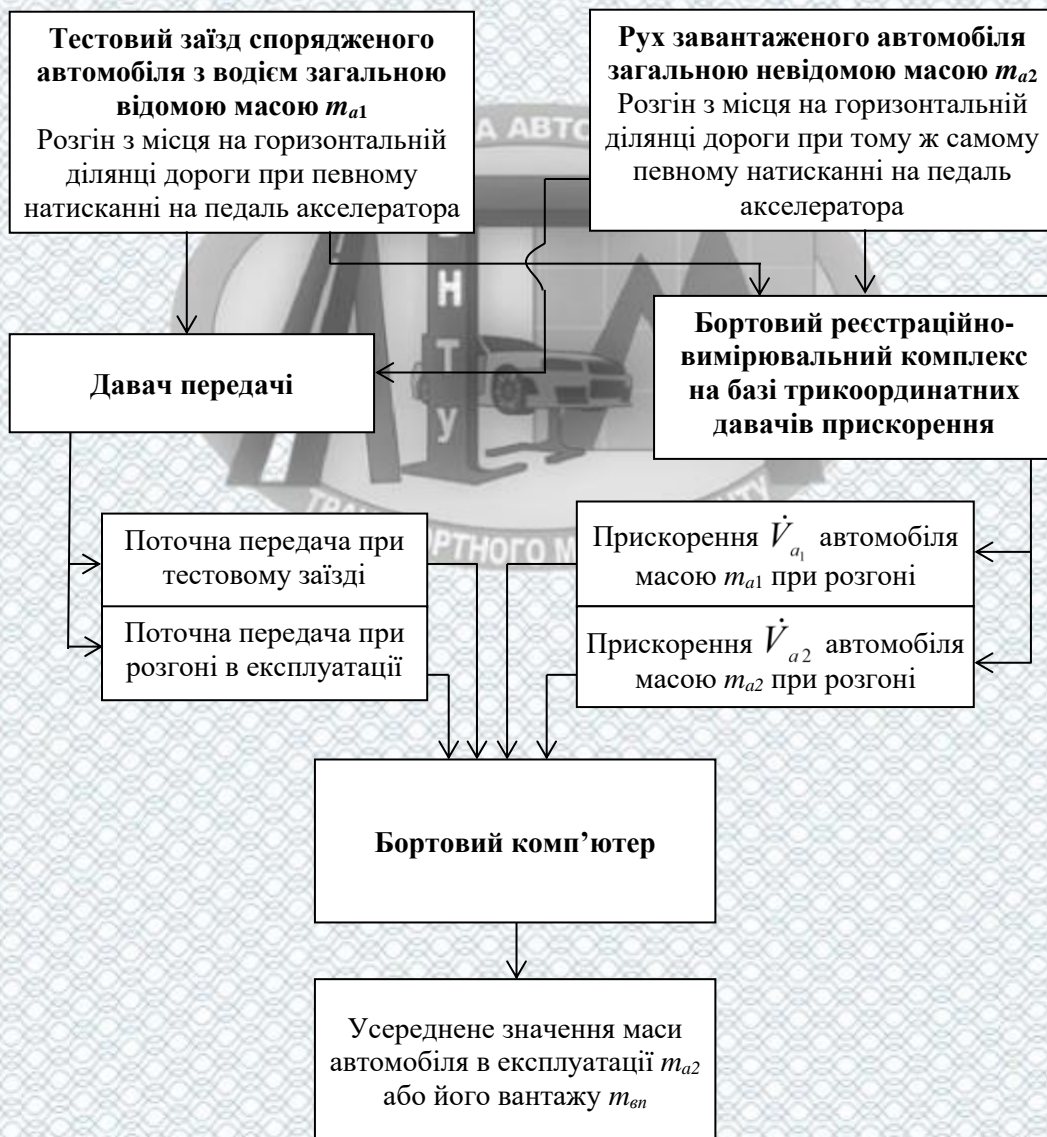
Рисунок 2.3 – Структурна схема методу визначення повної маси автомобіля та маси вантажу та (або) пасажирів в експлуатації
