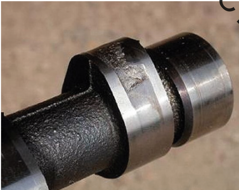
Рисунок 1.1– Фрагмент кулачкового вала з дефектами
