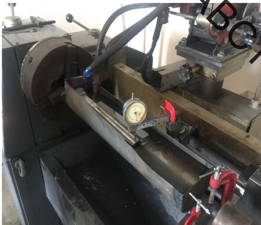
Рисунок 1.2 – Наплавлення валів у воді
