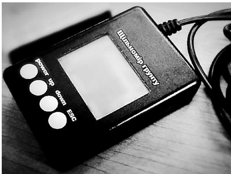
Рисунок 1.5 – Експериментальна модель мікроконтролера пристрою оперативного визначення глибини залягання плужної підшви
