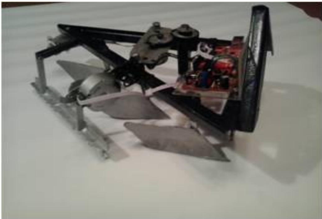
Рисунок 3.3 – Макетна модель трикорпусного плуга з вмонтованою системою моніторингу
