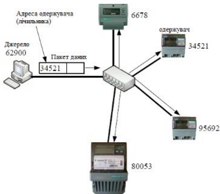
Рисунок 2.7 — Приклад роботи мережі з концентратором
