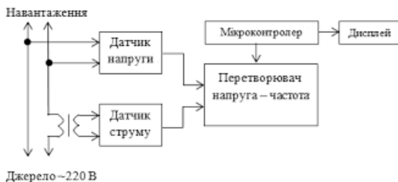
Рисунок 2.4 — Структурна схема цифрового лічильника електричної енергії
