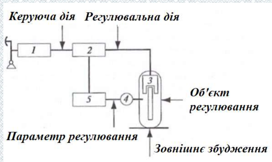
Рисунок 1.9 – Структурна схема антиблокувальної системи: 1 – головний гальмівний циліндр (гальмівний кран); 2 – регулювальний клапан АБС; 3 – колісний гальмівний циліндр (гальмівна камера); 4 – колісний датчик; 5 – блок керування.
