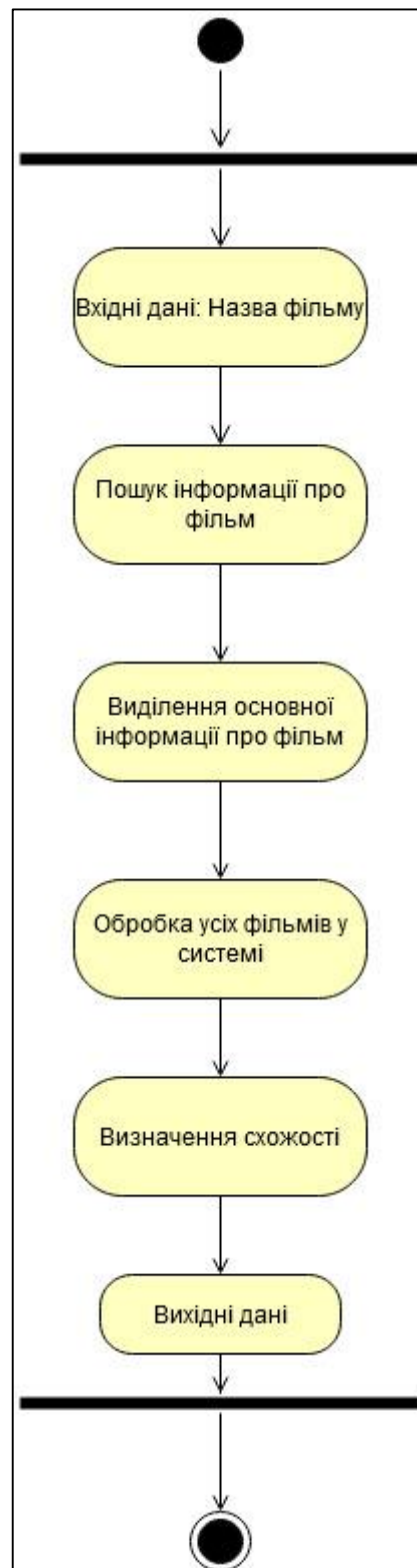
Рисунок 2.4 - Діаграма діяльності другого варіанту роботи модулю фільтрації на основі вмісту
