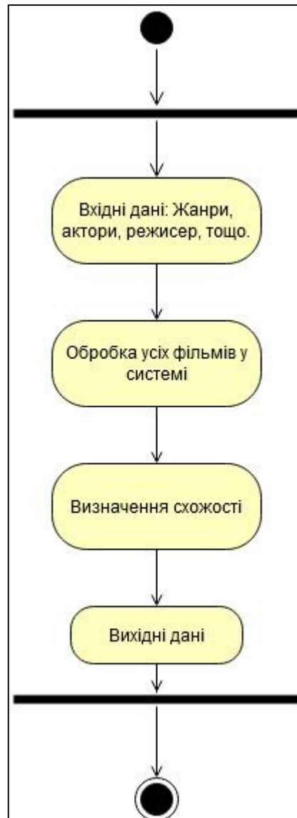
Рисунок 2.5 – Діаграма діяльності трього варіанту роботи модулю фільтрації на основі вмісту
