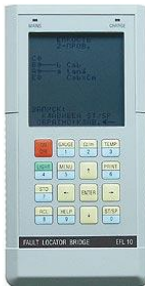
Рисунок 1.1 – Мультиметр для вимірювання параметрів лінії
