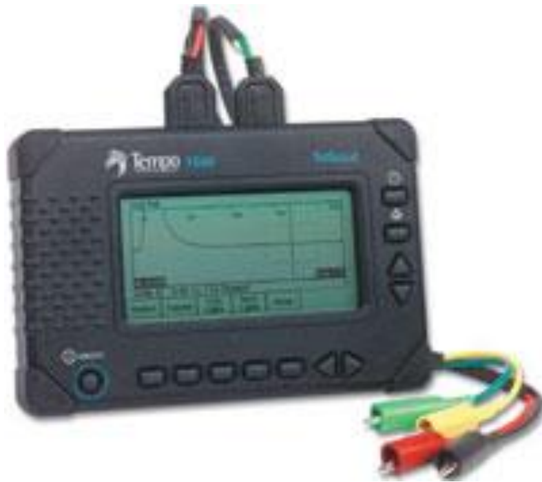
Рисунок 1.4 – Зовнішній вигляд рефлектометра TDR
