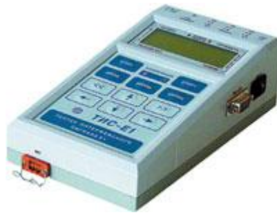
Рисунок 1.3 – Тестер коефіцієнта бітових помилок BER
