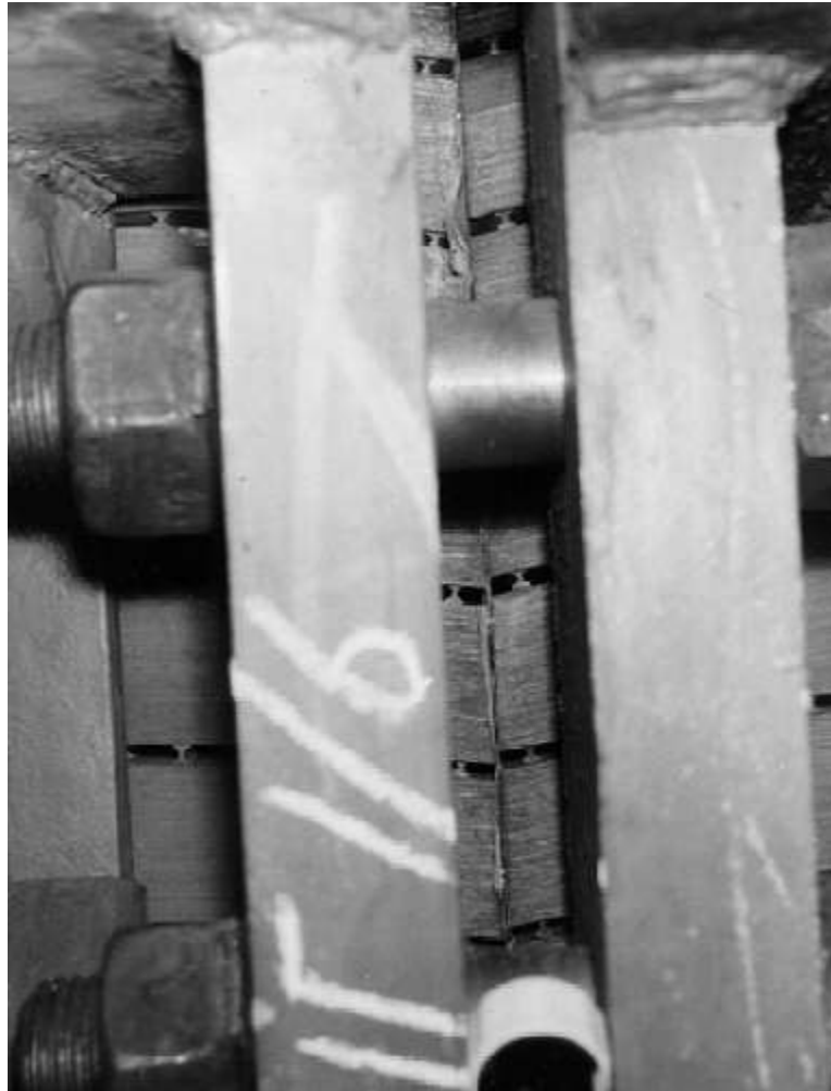
Рисунок 3.16 – Деформація заліза статора гідрогенератора в місці стику секторів сердечника.
