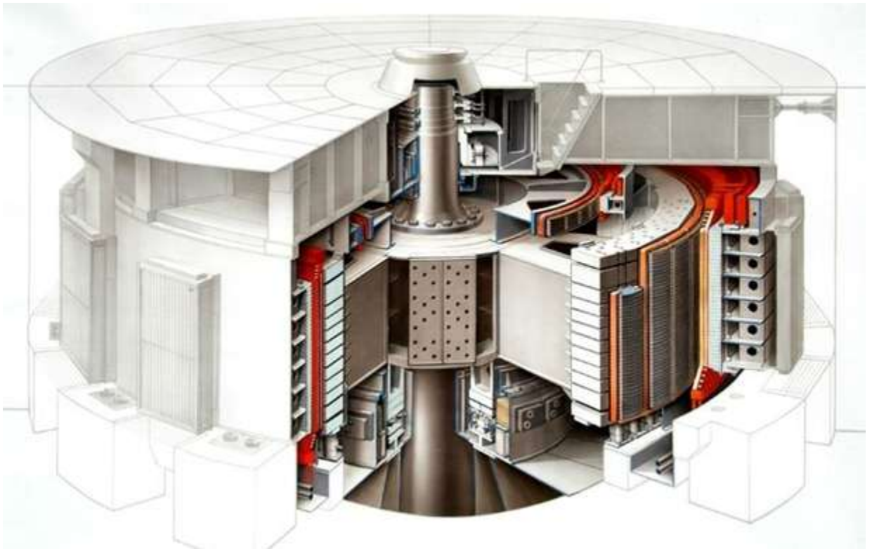
Рисунок 3.3 – Загальний вигляд потужного гідрогенератора
