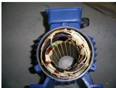
Бандажна стрічка пошкоджена біля згорілої обмотки
