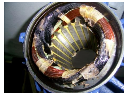
Бандажна стрічка пошкоджена біля згорілої обмотки
