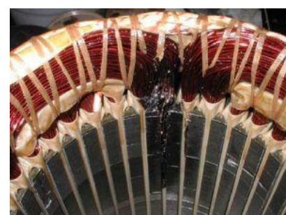
Бандажна стрічка пошкоджена біля згорілої обмотки
