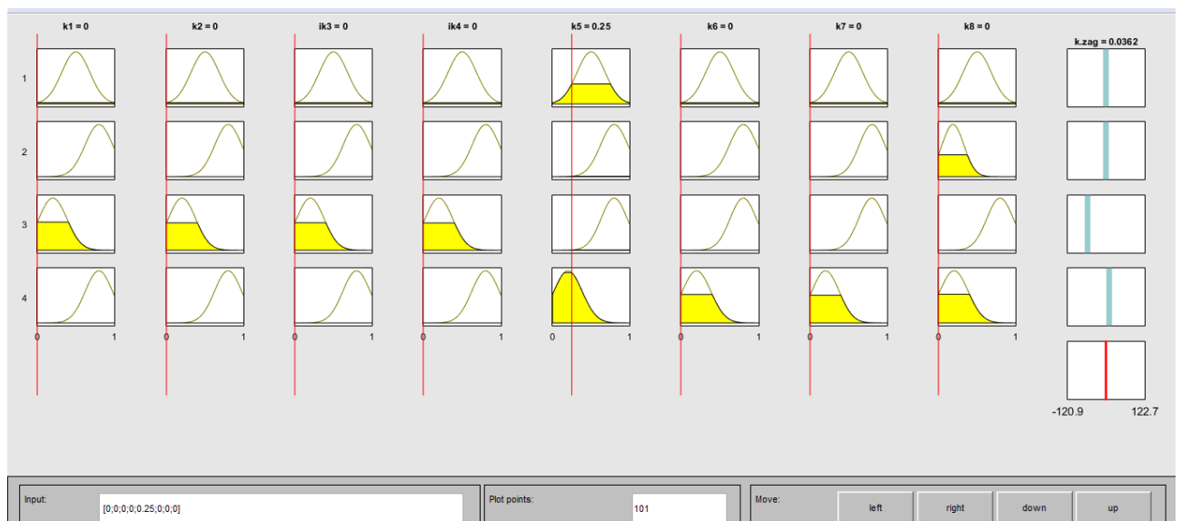
Рисунок 3.12 – Визначення коефіцієнта залишкового ресурсу ЕД при значеннях всіх вхідних параметрів 1 в.о
