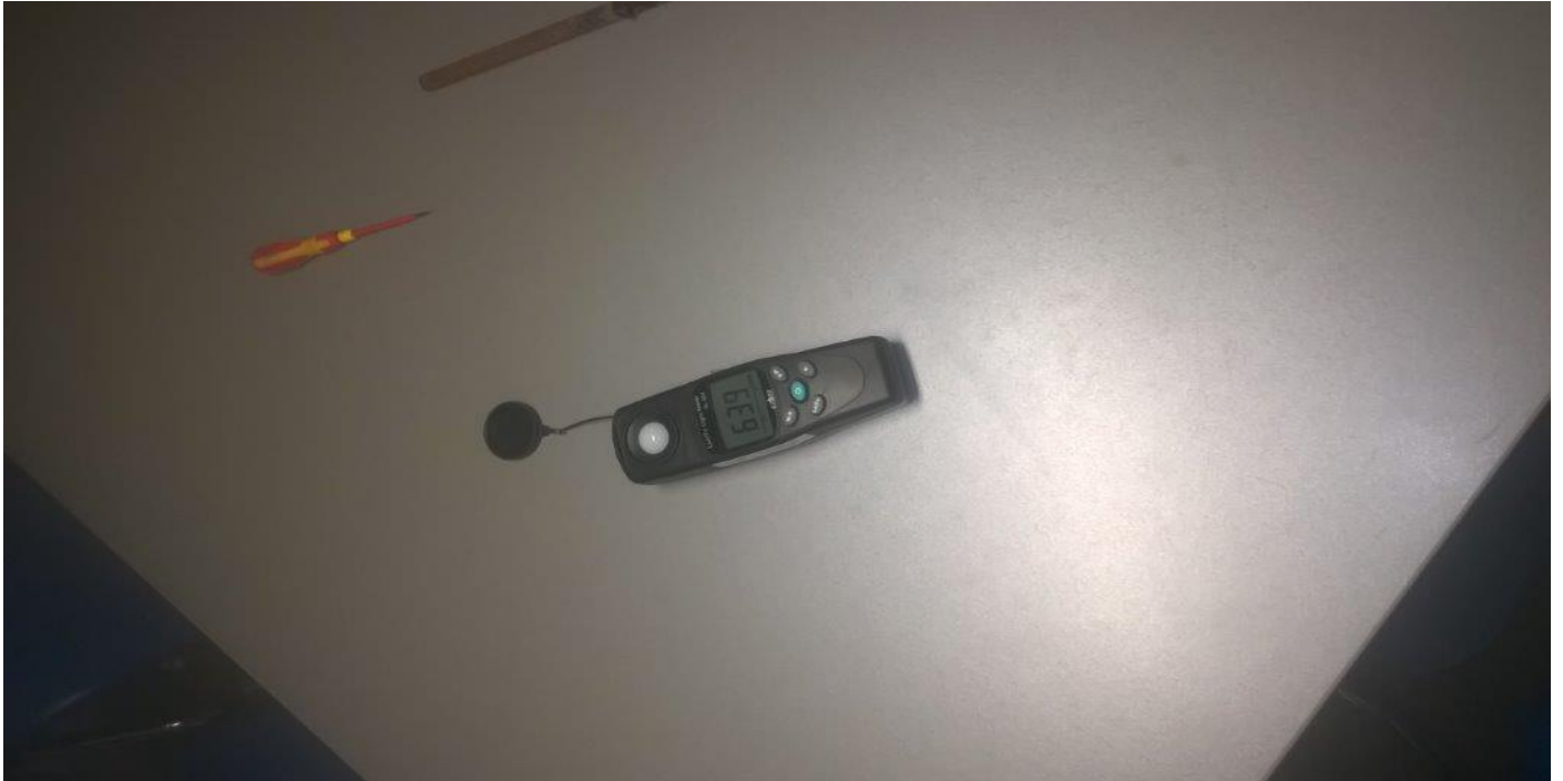
Рисунок Й.1 – Вимірювання освітленості, що створюється LED-лампою
