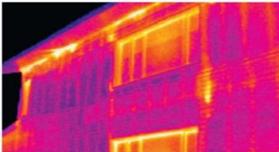
Рисунок 3.6 – Втрати тепла в конструкціях будівлі
