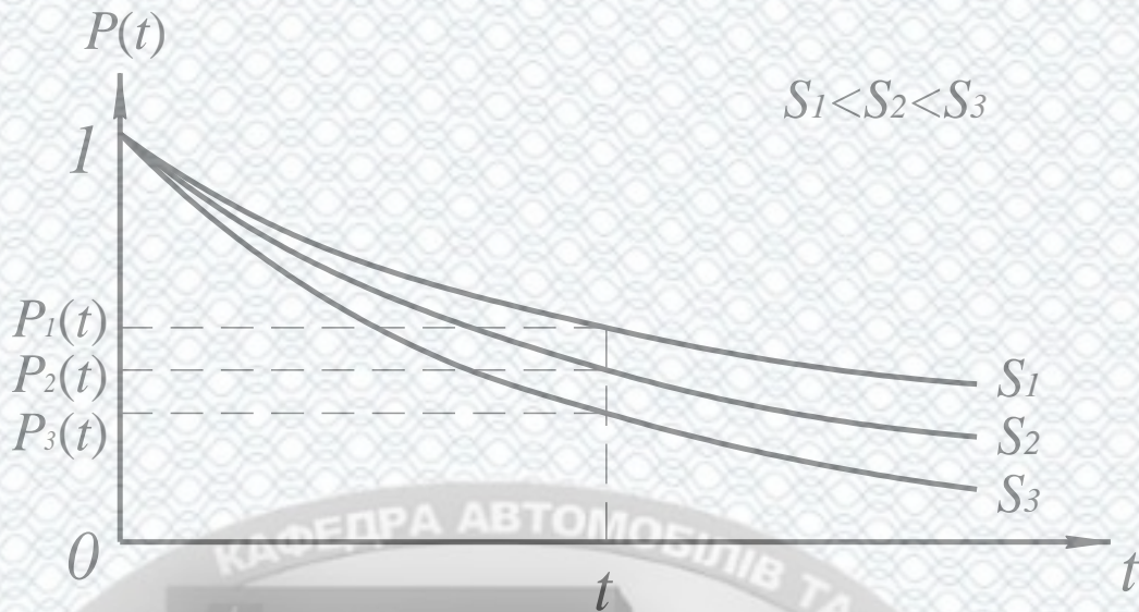
Рисунок 2.1 - Залежність імовірності безвідмовної роботи автомобіля від часу: P_1(t) , P_2(t) , P_3(t) - імовірності безвідмовної роботи в момент часу t для автомобілів з напрацюванням S_1 , S_2 , S_3 відповідно.
