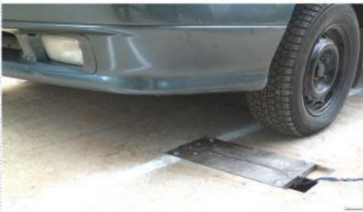
Рисунок 1.9 - Зовнішній вигляд вмонтованого в опорну поверхню датчика для вимірювання сил в зоні контакту шини з дорогою
