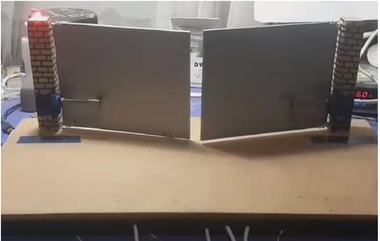
Рисунок 3.1 – Зовнішній вигляд лабораторного стенда для вивчення процесу автоматизації системи відкривання воріт
