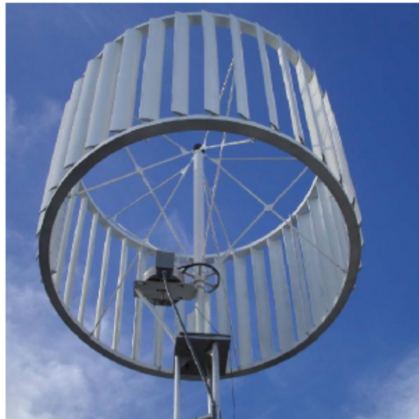
Рисунок 2.10 – Зовнішній вигляд багатолопатевого ротора
