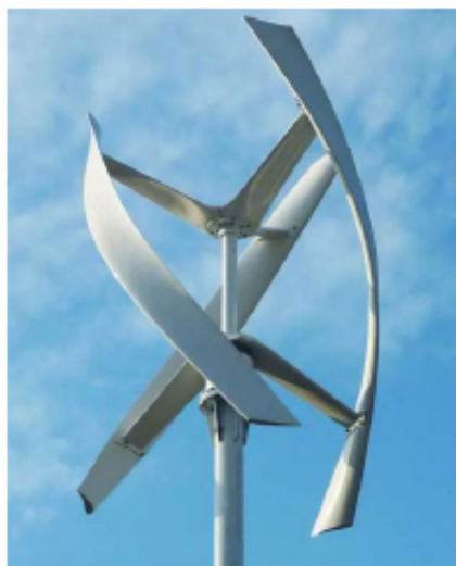
Рисунок 2.9 – Зовнішній вигляд гелікоїдного ротора
