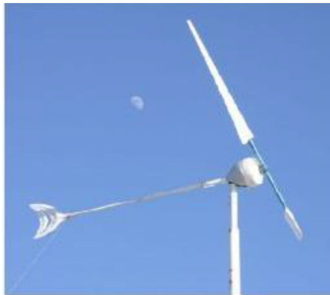
Рисунок 2.3 – Зовнішній вигляд однолопатевого вітрогенератора
