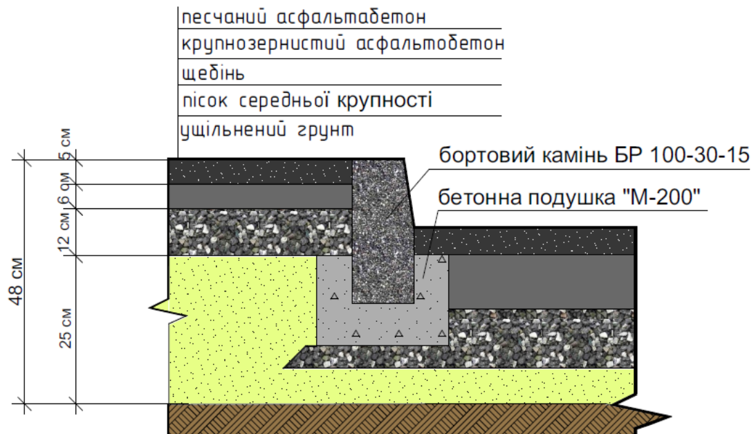
Рисунок 3.2 – Конструкції дорожнього покриття проїжджої частини
