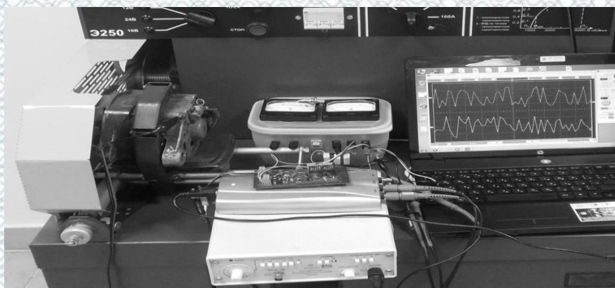
Рисунок 3.1 – Установка для проведення дослідів на двохопороному вузлі
