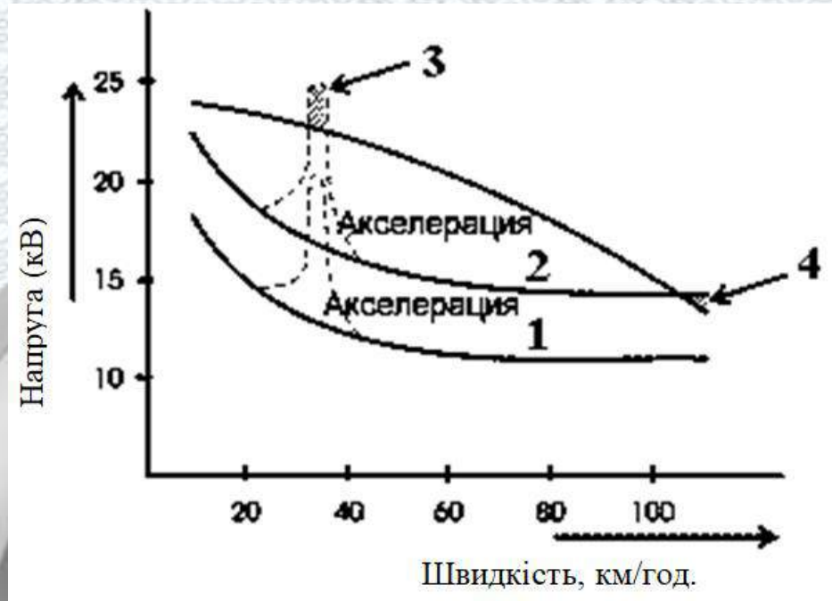
Рисунок 3.16 - Залежність електричної напруги від швидкості автомобіля: 1 - напруга, необхідна для свічок запалювання (нова); 2 - напруга, необхідна свічки запалювання (колишня у вживанні); 3 - напруга, що подавати системою запалювання; 4 - недостатня напруга, що слід подавати системою
