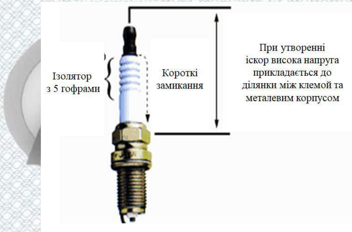
Рисунок 4.1 Конструкція свічі запалювання з п'ятьма гофрами
