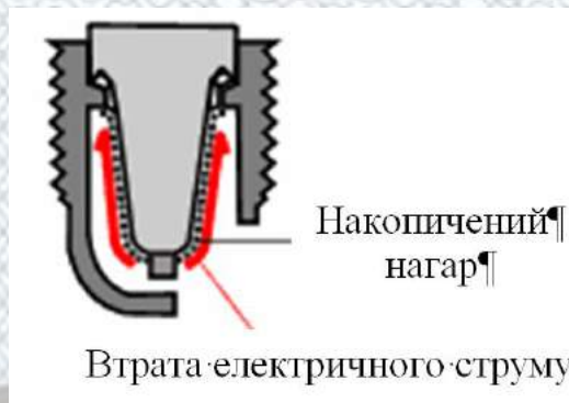
Рисунок 3.10 – Нагар і витік електричного струму
