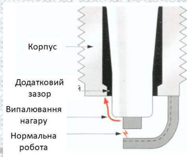
Рисунок 3.9 - Свічі запалювання з напівповерхневим зазором
