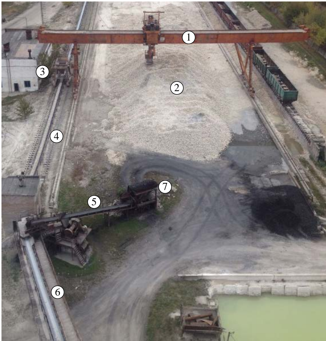
Рисунок 1.4 – Подача вапняку до скіпового підйомника вапнякової печі:
