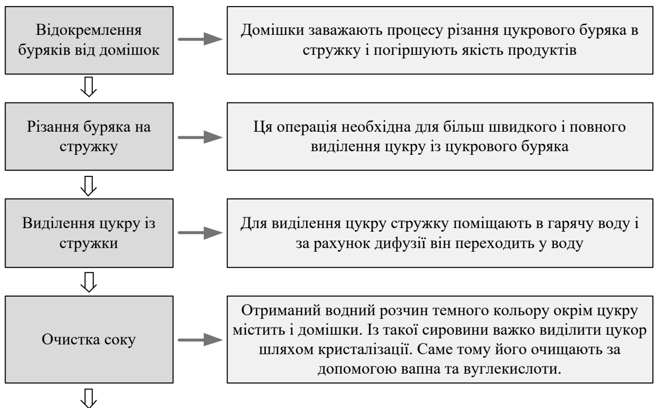
Рисунок 1.1 – Етапи виробництва цукру із цукрового буряка [5]
