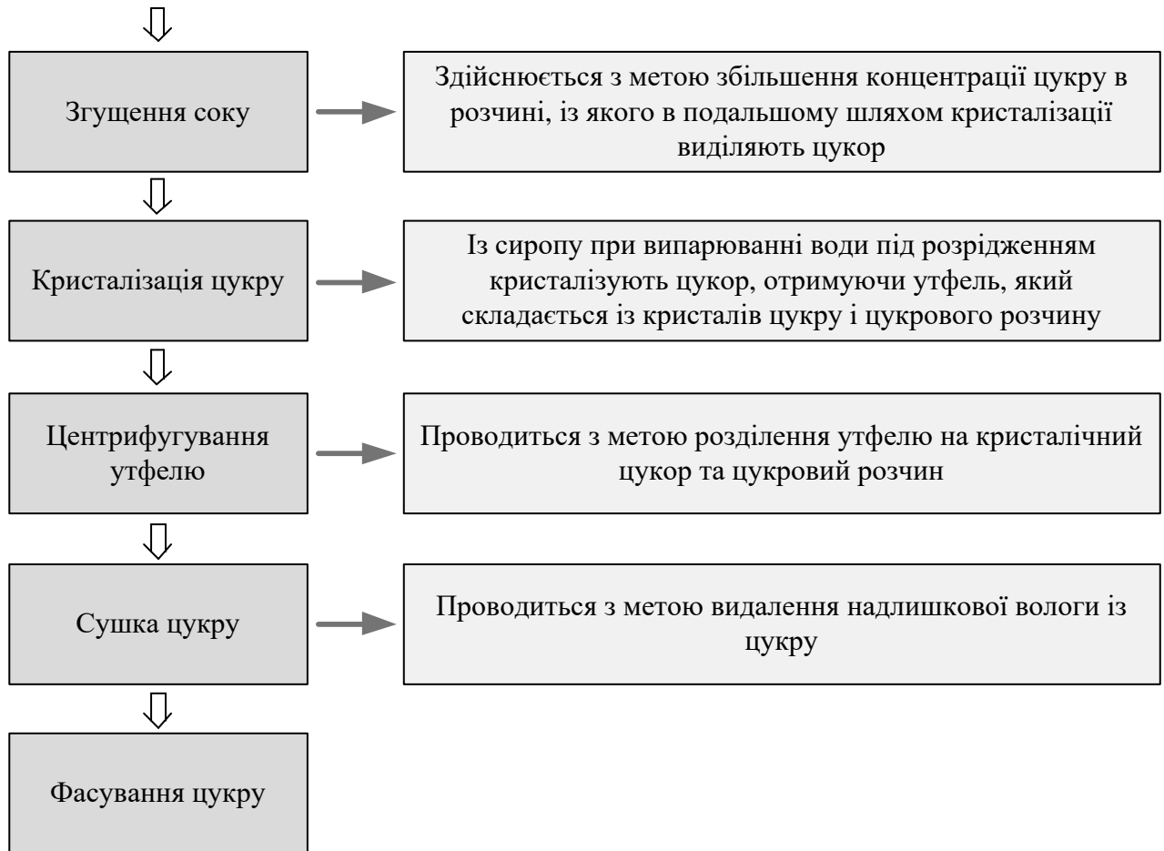
Рисунок 1.2 – Етапи виробництва цукру із цукрового буряка (продовження) [5]
