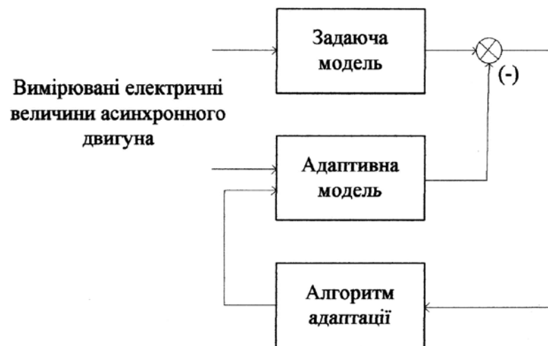
Рисунок 3.1 – Загальна структура адаптивної системи з задаючою моделлю
