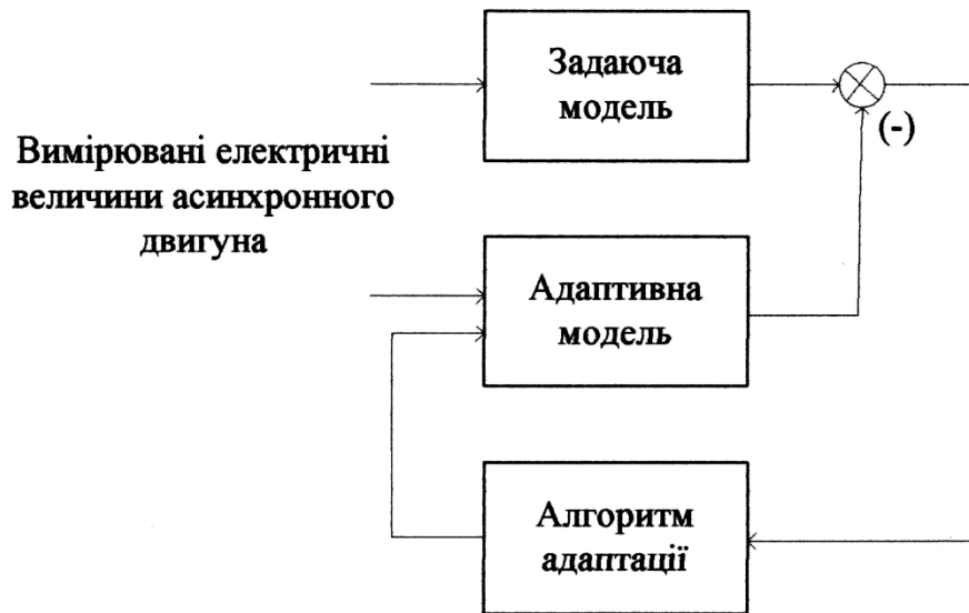
Загальна структура адаптивної системи з задаючою моделлю
