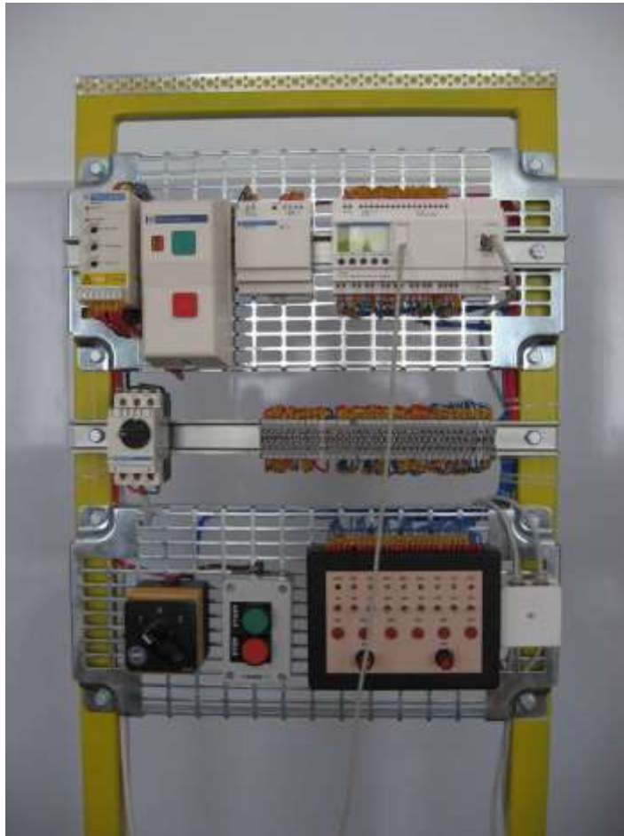
Рисунок 1.2 – Зовнішній вигляд стенда для дослідження програмованого логічного контролера Zelio
