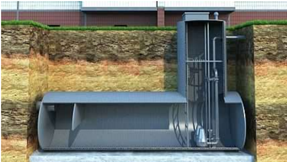
Рисунок 1.2 – Зовнішній вигляд каналізаційної насосної станції горизонтального типу
