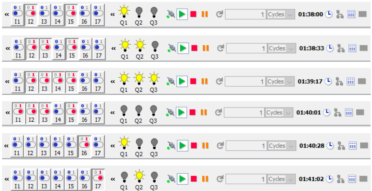
Рисунок 5.10 – Режим симуляції програмного середовища Logo Soft Comfort V8
