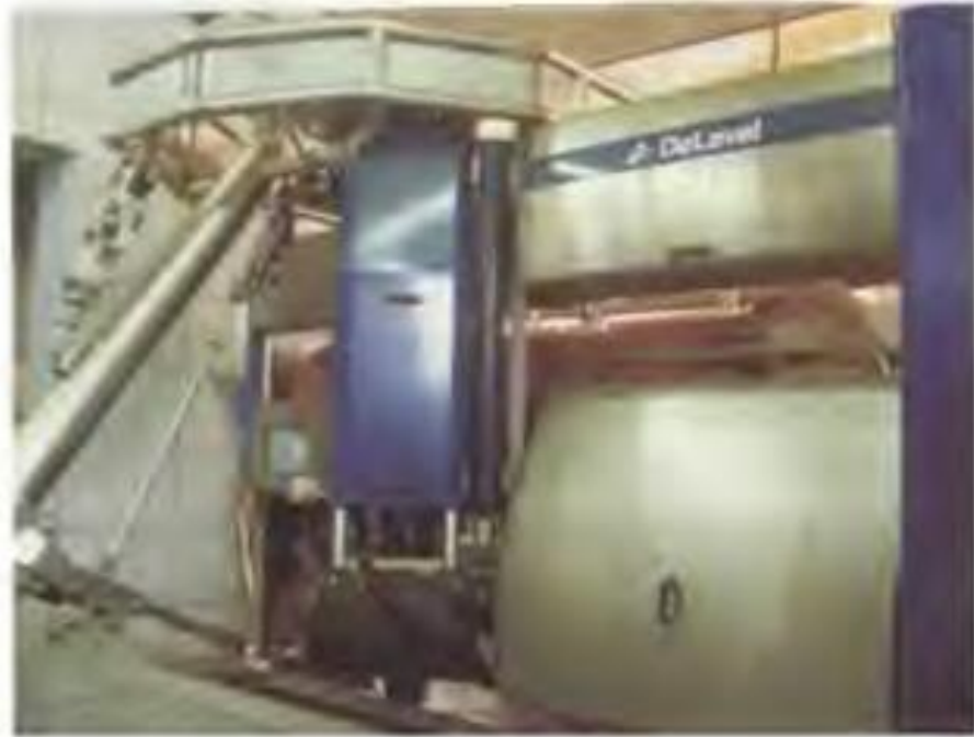
Рисунок 1.2 – Система автоматичного доїння, яка оснащена датчиками контролю молока
