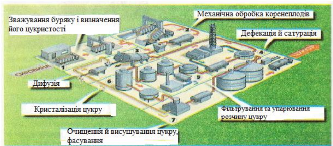
Рисунок 3.1 – Загальна схема цукрового заводу
