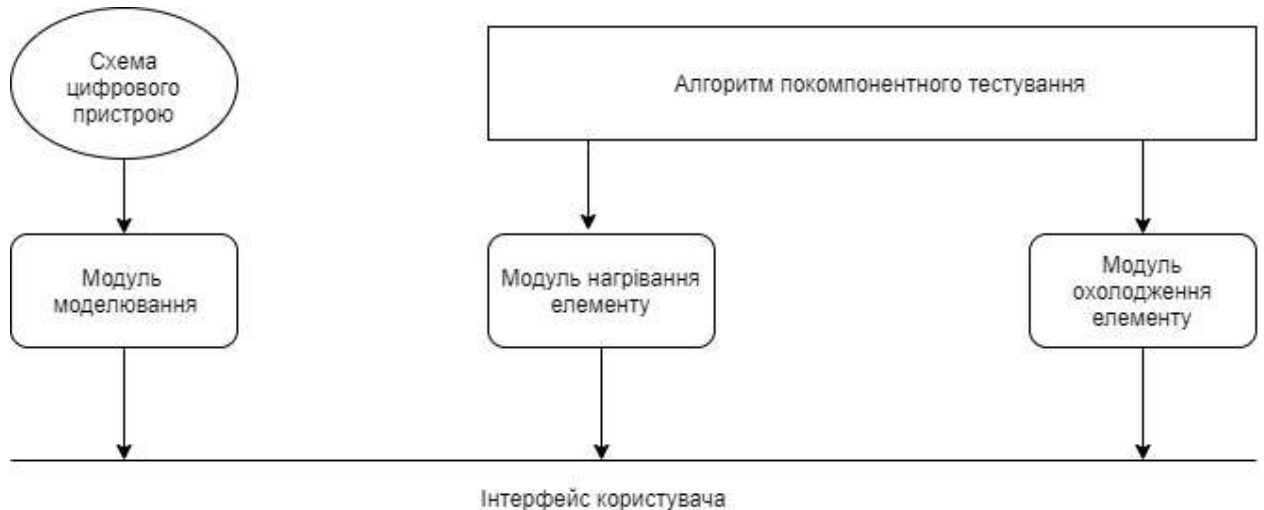
Рисунок 3.1 – Структурна схема системи безпечного тестування схем цифрових пристроїв
