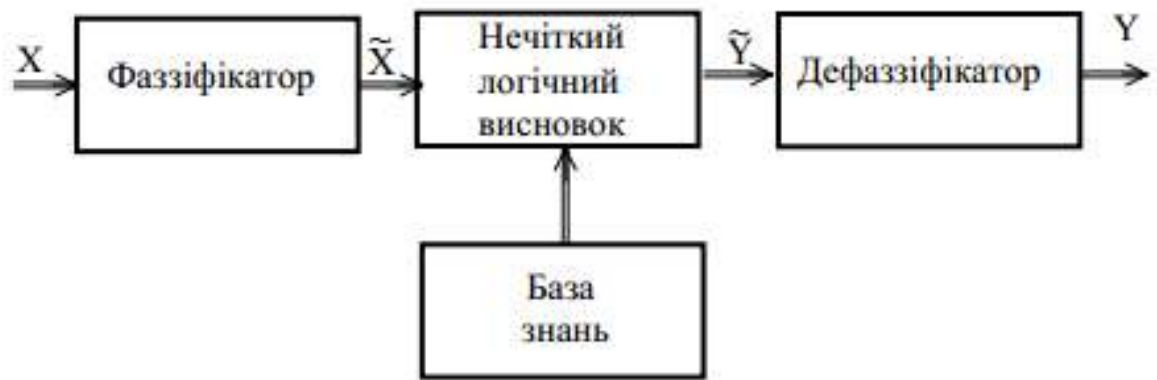
Рисунок 2.1 – Узагальнена структура системи нечіткого логічного висновку
