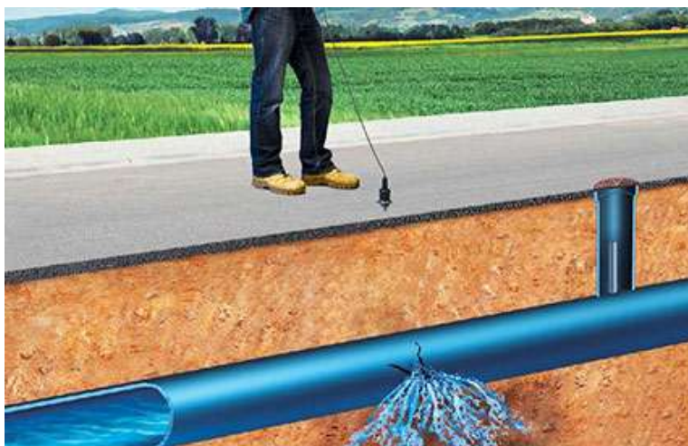
Рисунок 1.2 –Метод пасивної локації для локалізації витоків підземних трубопроводів
