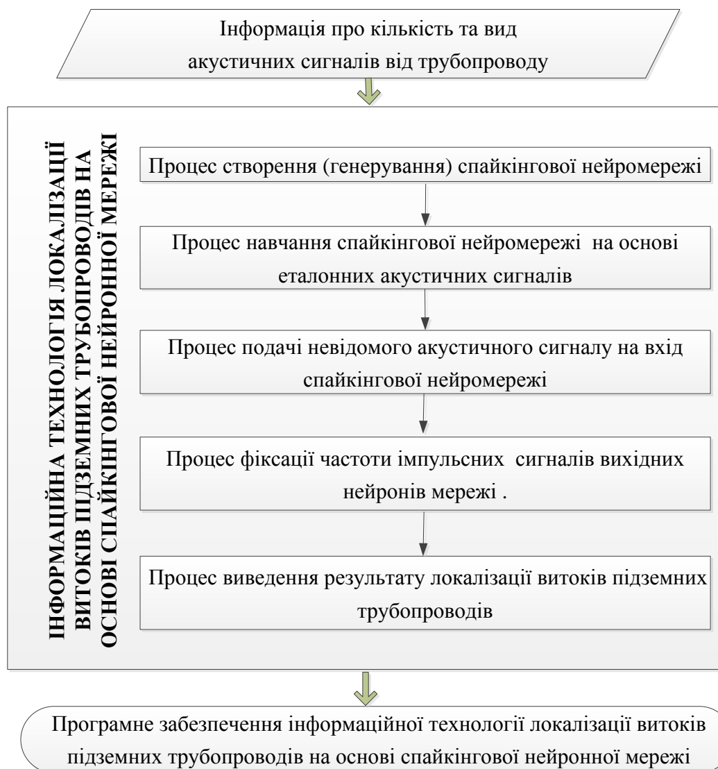
Рисунок 2.4 - Структура інформаційної технології локалізації витоків підземних трубопроводів на основі спайкінгової нейронної мережі
