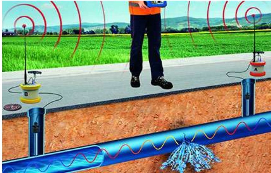
Рисунок 1.4 – Кореляційний метод локації для локалізації витоків підземних трубопроводів.
