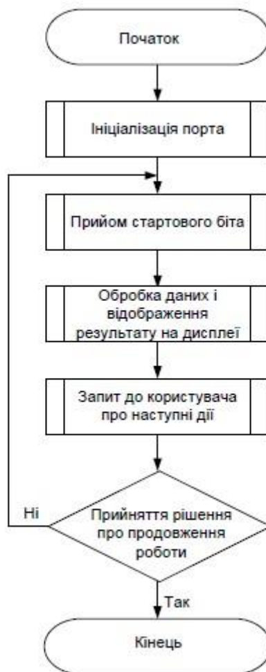
Рисунок 4.3 – Блок-схема алгоритму роботи персонального комп'ютера
