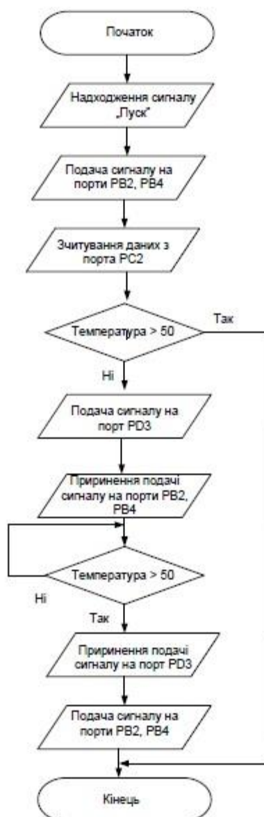
Рисунок 4.1 – Блок-схема алгоритму роботи мікроконтролера гарячого водопостачання
