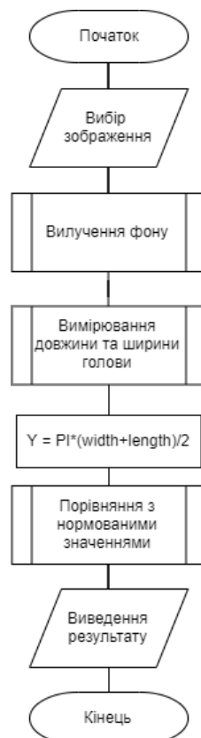
Рисунок 3.16 – Блок-схема алгоритму роботи модуля для оцінки розвитку дитини
