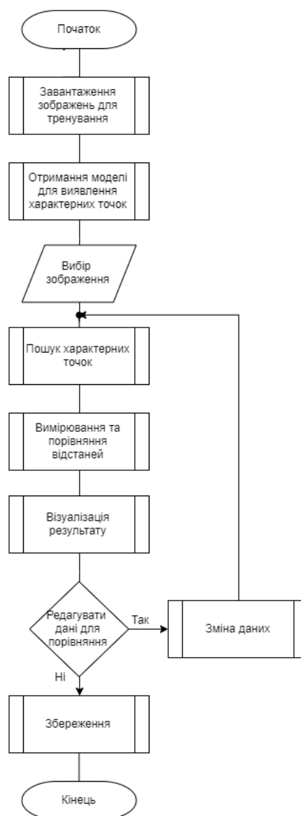
Рисунок 3.15 – Блок-схема алгоритму роботи модуля для експрес-діагностування генетичних захворювань
