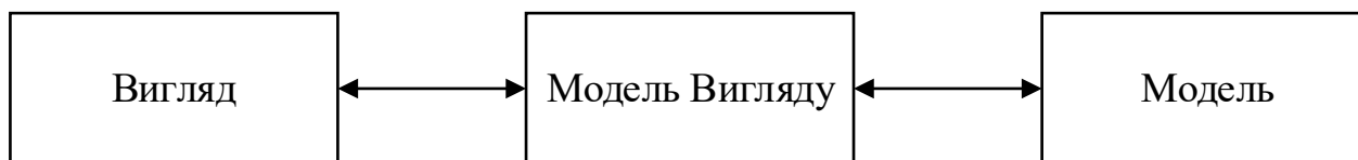
Рисунок 3.4 – Схема шаблону Модель-Вигляд-Модель Вигляду
