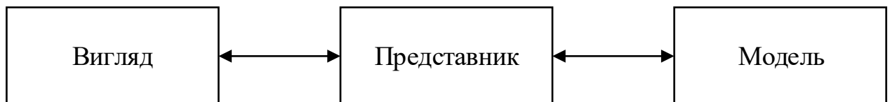
Рисунок 3.3 – Схема шаблону Модель-Вигляд-Представник
