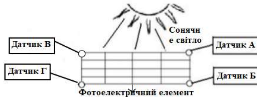
Рисунок 3.3 – Розміщення фоторезисторів на сонячній панелі
