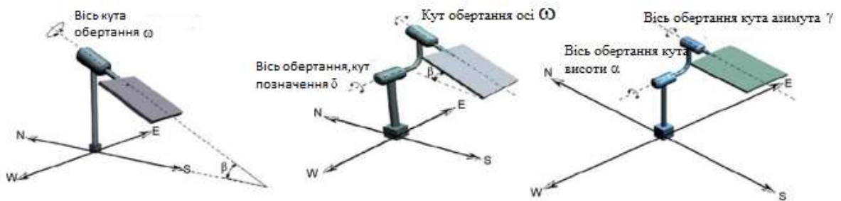
Рисунок 2.8 – Зліва направо. Одновісна система стеження сонця з кутом нахилу, рівною ширині кута; екваторіальна система відстежування сонця з кутом нахилу, рівною широті; система орієнтації сонця з двома осями азимуту \omega
