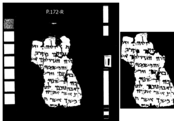
Рисунок 3.4 – Обрізаний текст за допомогою методу з'єднаних компонент
