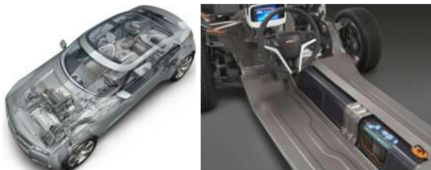
Рисунок 3.4 – Гібридна технологія E-REV автомобіля Chevrolet Volt
