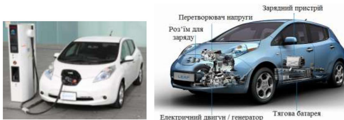
Рисунок 3.2 – Електромобіль Nissan Leaf та його силова установка
