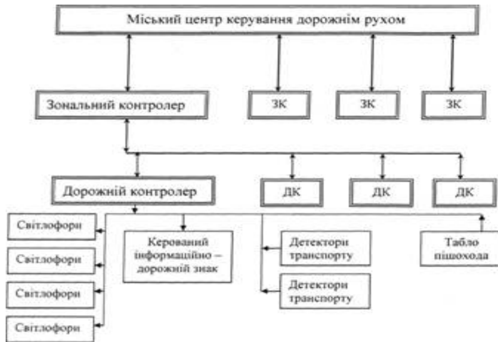
Рисунок 2.1 – Ієрархічна структура системи керування дорожнім рухом
