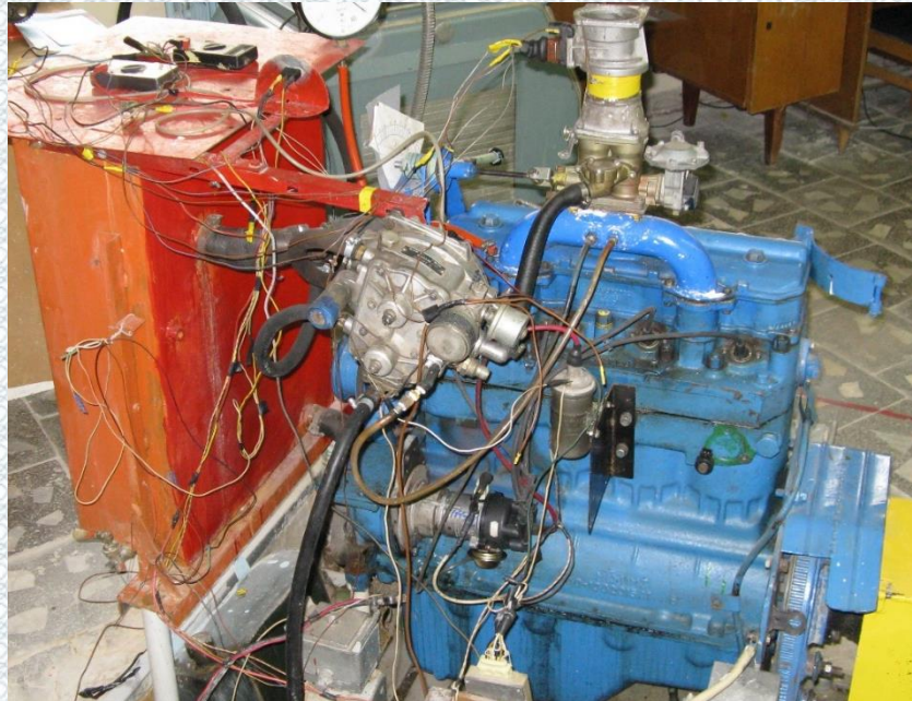
Рисунок 4.2 – Дизель Д-240, переобладнаний для роботи на ПГ
