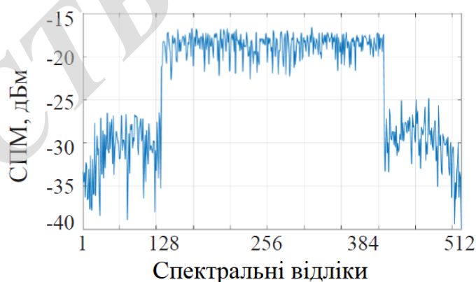
Рисунок 4.11 – Спектральні відліки прийнятого OFDM символу
