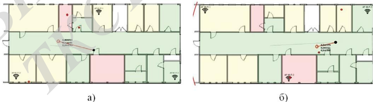
Рисунок 2.7 – Схема оптимального розташування трьох точок доступу на досліджуваній схемі поверху з точки зору мінімальної помилки визначення місця розташування: а) карта № 3, б) карта № 6
