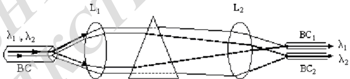
Рисунок 3.7 - Схема розділення оптичних носійних за допомогою призми.
