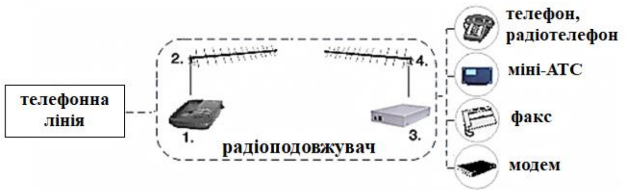
Рисунок 1.6 - Схема побудови радіо подовжувача
