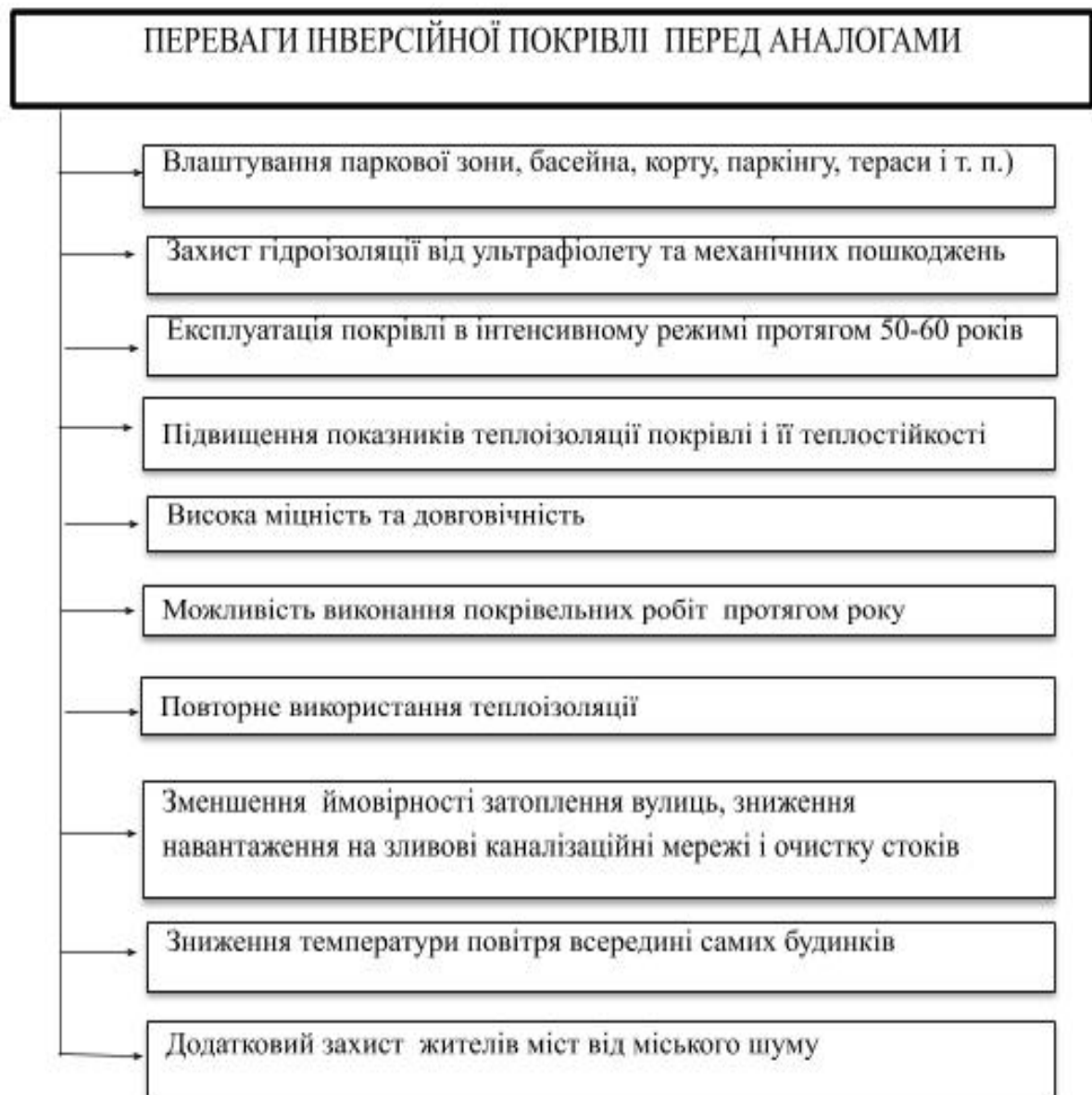
Рисунок 2.8 – Переваги інверсійних покрівель перед традиційними плоскими покрівлями
