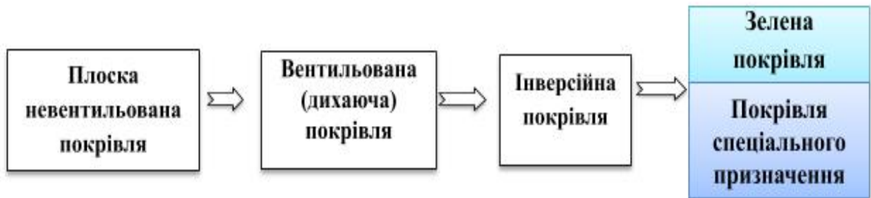
Рисунок 2.3 – Основні етапи вдосконалення плоскої покрівлі
