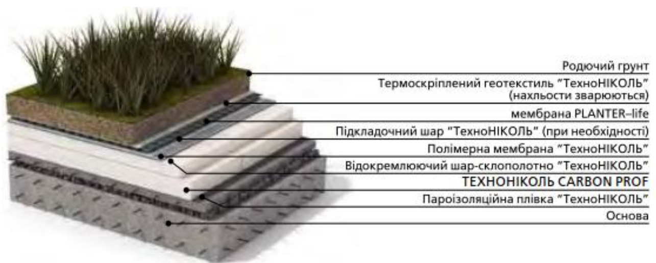
Рисунок 2.7 – Типова конструктивна схема «зеленої» покрівлі
