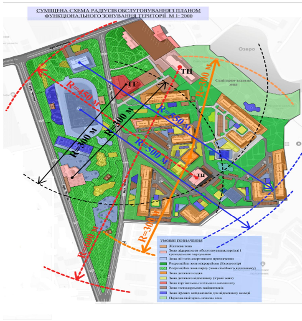
Рисунок 3.9 – Суміщена схема радіусів обслуговування з планом функціонального зонування території мікрорайону
