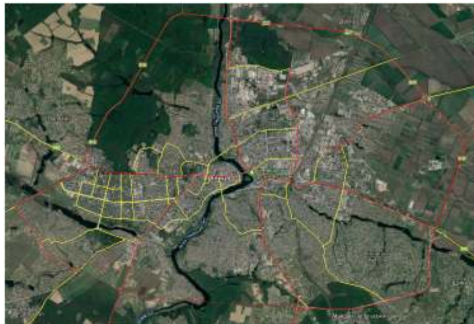
Рис. 1.6 – Доформування радіального кільця у планувальній схемі ВДМ м. Вінниці
