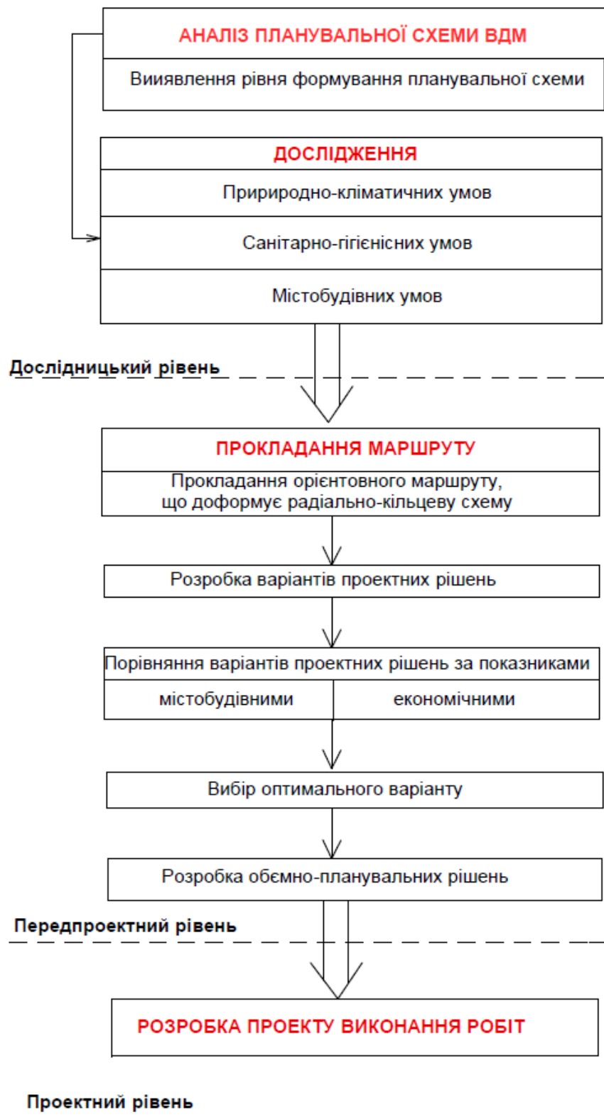
Рис. 1.1 – Алгоритм розвантаження ВДМ шляхом доформування радіально-кільцевої схеми
