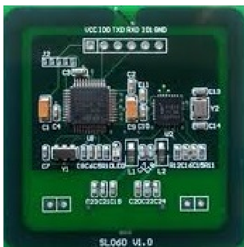
Рисунок 1.8. – Зовнішній вигляд модуля SL060 для зчитування NFC-міток
