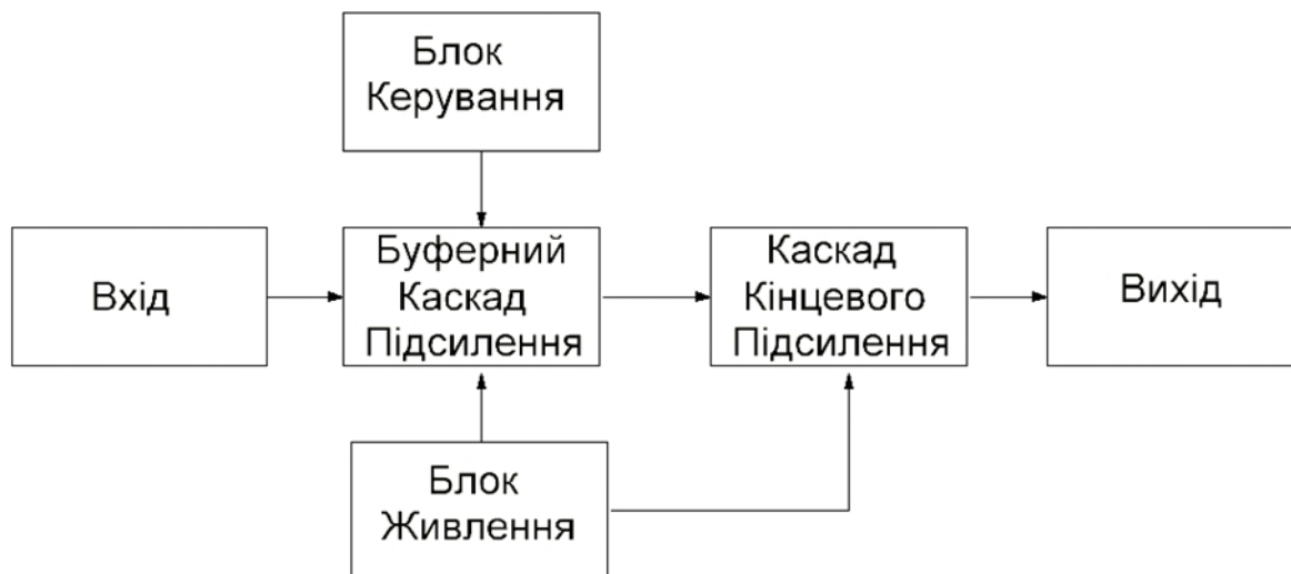
Рисунок 2.1 – Структурна схема слухового апарату на основі підсилювача
