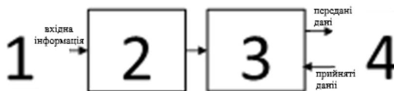
Рисунок 2.1 – Мікроконтролер : 1 – керуючий блок 2 – демультиплексор; 3 – мікропроцесор; 4 – блок прийому та передачі даних;
